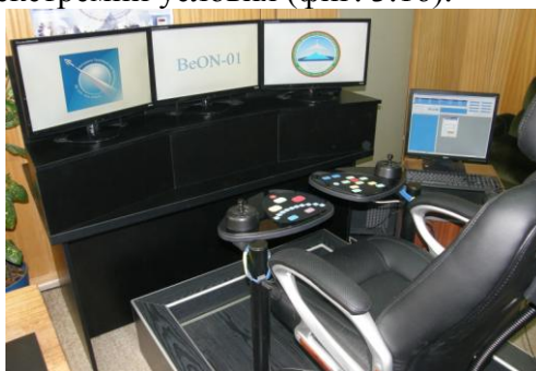
Фиг. 3.16. Комплекс НИК ВеОн-1 за изследване на оператори в екстремни условия
